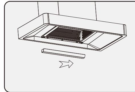
按图所示的位置，将油杯延着油网导轨的方向水平插入或抽出，以安装或取出油杯。
