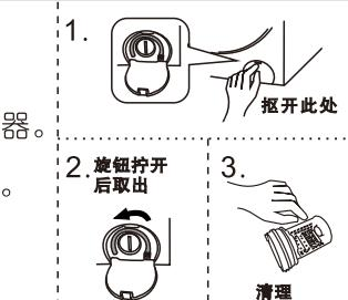
注意：1. 过滤器必须旋紧以免导致漏水；
