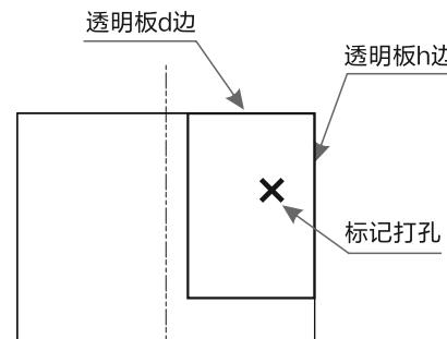
3: 将上固定贴组件正面紧靠冷藏门背面，调整位置使在步骤1中做标记的孔位对准步骤2中打好的孔，然后用固定螺钉（8）固定此孔位。调整上固定铁组件位置，将其底边与橱柜门顶面平行，然后用固定螺钉（8）固定其余孔位（共8处）。
