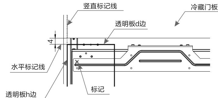
2、把冷冻门板背面朝上放在平整且干净的地面上。将透明板（20）h边对齐冷冻门板背面的右侧面，d边对齐冷冻门板的顶面，用固定螺钉（8）在标记处打孔。
