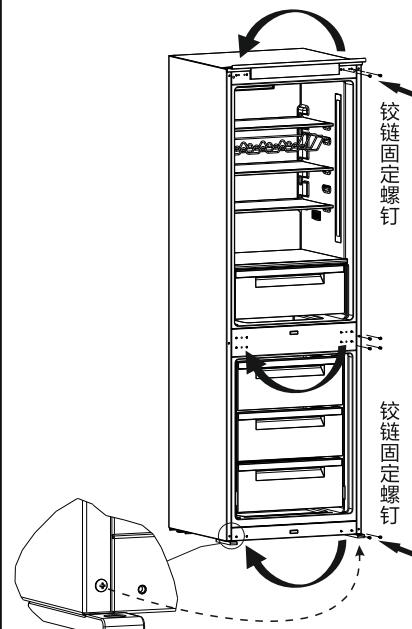
6: 将冰箱门铰链的孔对准预先装好的螺钉，冰箱门（带铰链）往里推，然后向右移动，最后拧紧铰链固定螺钉。
