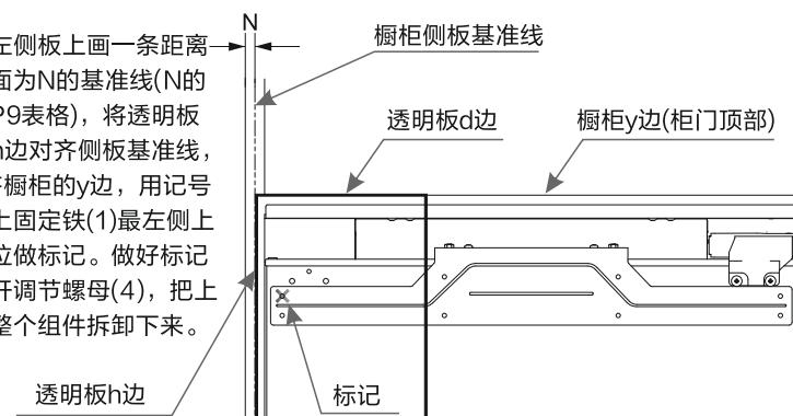
2: 把冷藏门板背面朝上放在平整且干净的地面上。将透明板（20）h边对齐冷藏门板背面的右侧面，d边对齐冷藏门板的顶面，用固定螺钉（8）在标记处打孔。
