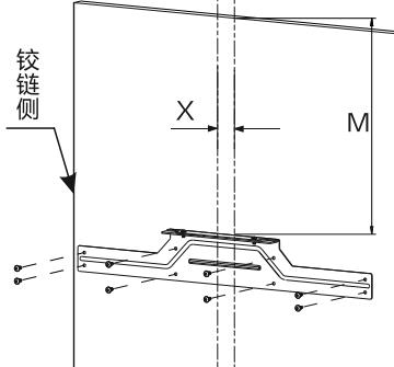
4: 打开冰箱门，将装好的冷藏门板挂在冰箱门顶部的调节螺钉（3）上，并拧上调节螺母（4）。可暂时不拧紧螺母，以便调节柜门的水平位置。
