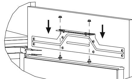
5: 关上门，将冷藏门板调整到左右居中的位置，打开门固定调节螺母（4）
