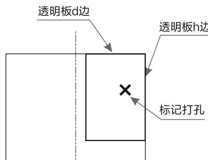
3、将上固定铁组件正面紧靠冷冻门板背面，调整位置使步骤1中做标记的孔位对准步骤2中打好的孔，然后用固定螺钉（8）固定此孔位。调节上固定铁组件将其底边与冷冻门板顶面平行，然后用固定螺钉（8）固定其余孔位。
