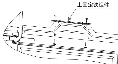
3: 把冷藏门板背面朝上放在平整且干净的地面上。将上固定铁组件正面紧靠冷藏门板背面，调整位置使上固定铁组件顶部到冷藏门板顶部的距离为M，且上固定铁组件的中心线向铰链侧偏移X。位置调整完毕后用固定螺钉(8)固定。
