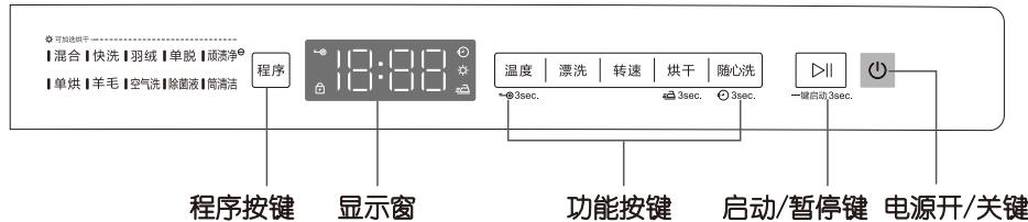
程序按键 显示窗 功能按键 启动/暂停键 电源开/关键
